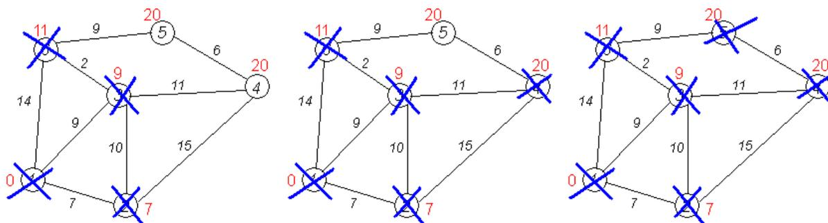
**Завершение выполнения алгоритма.** Алгоритм заканчивает работу, когда вычеркнуты все вершины. Результат его работы виден на последнем рисунке: кратчайший путь от вершины 1 до 2-й составляет 7, до 3-й — 9, до 4-й — 20, до 5-й — 20, до 6-й — 11.
